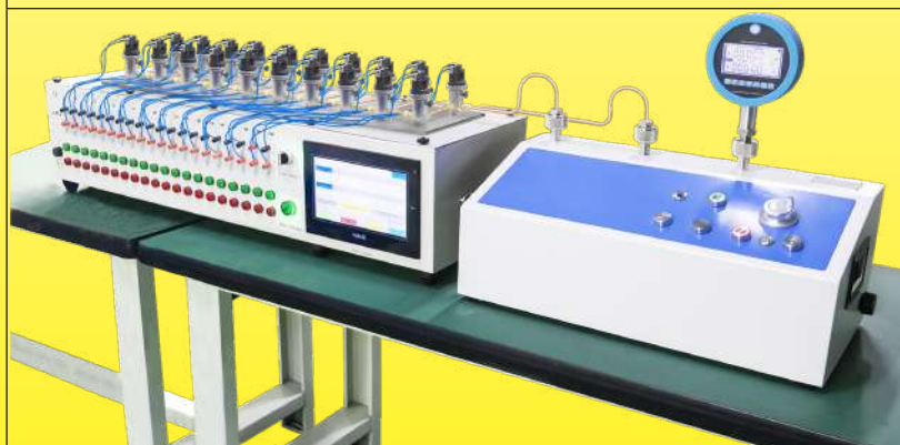
Vérification de l'étalonnage des pressostats
