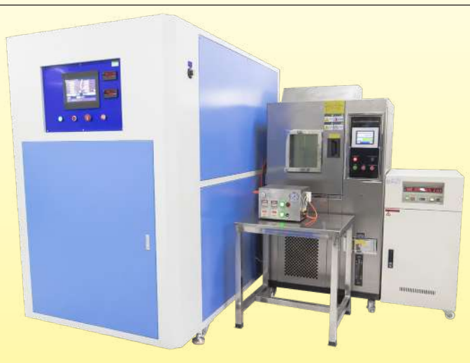
Equipement d'essai de durée de vie électrique des air switches. (Utilisé pour la vérification de la conformité aux normes UL et CE applicables)
