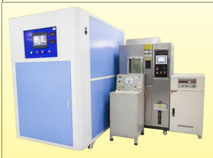
Equipement d'essai de durée de vie électrique des pressostats (Utilisé pour la vérification de la conformité aux normes UL et CE applicables)
