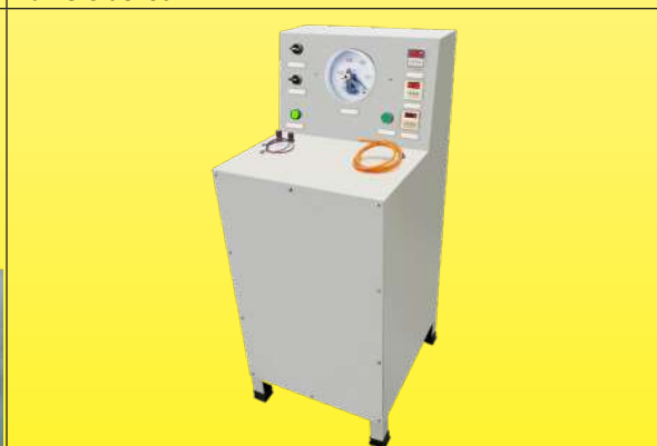
Vérification des cycles de fonctionnement des air switches
