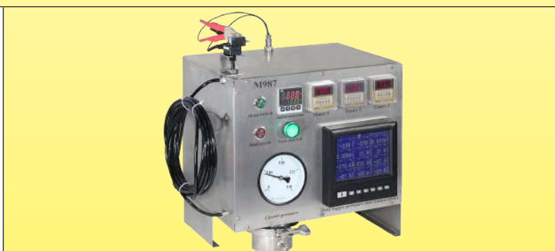
Equipement d'essai permettant de mesurer de manière répétitive et constante la longueur maximale des tubes de liaison des air switches en fonction du volume du bouton poussoir et de la pression qu'il développe (Laboratoire Ultimheat)
